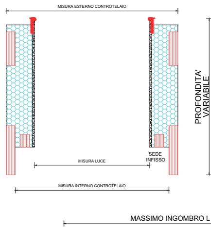
Monoblocco PER SOLO INFISSO composto da **CONTROTELAIO IN LEGNO MULTISTRATO FENOLICO** assemblato con **SPALLA IN XPS DA 40/60 mm RIVESTITA CON FIBROCEMENTO DA 5 mm "modello Ante solo infisso"**.
