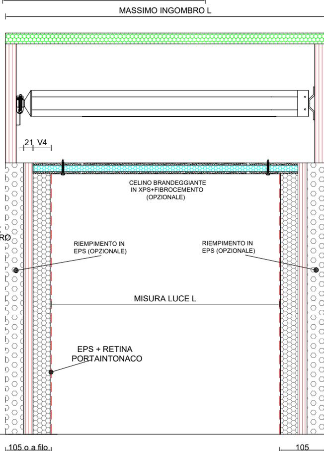
Monoblocco composto da **CONTROTELAIO IN LEGNO MULTISTRATO FENOLICO + ALLUMINIO, SPALLA COIBENTATA IN EPS DA 40/60 mm + RETE PER RASATURA e CASSONETTO COIBENTATO IN POLISTIRENE LINEA PLUS.** Fornito completo di celino brandeggiante in XPS e Fibrocemento (opzionale non compreso nel prezzo) e accessori per tapparella con motore.
