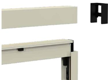
Regolazione guida superiore per compensazione vano irregolare
